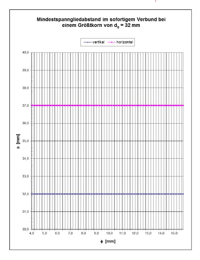
Mit Hilfe dieser beiden Diagramme können sehr schnell die Mindestabstände  $a_v$  und  $a_h$  für Spannglieder im sofortigen Verbund mit einem Spannglieddurchmesser 4,0 mm  $\leq \emptyset \leq$  15,7 mm ermittelt werden.
