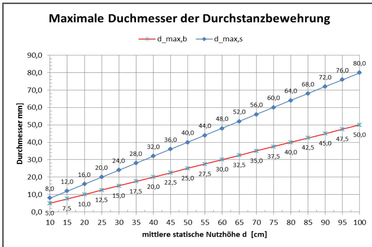
Mit Hilfe dieses Diagramms können sehr schnell die Maximaldurchmesser für Durchstanzbewehrung aus Bügeln  $\varnothing_{\max,b}$  oder Schrägaufbiegungen  $\varnothing_{\max,s}$  ermittelt werden.
