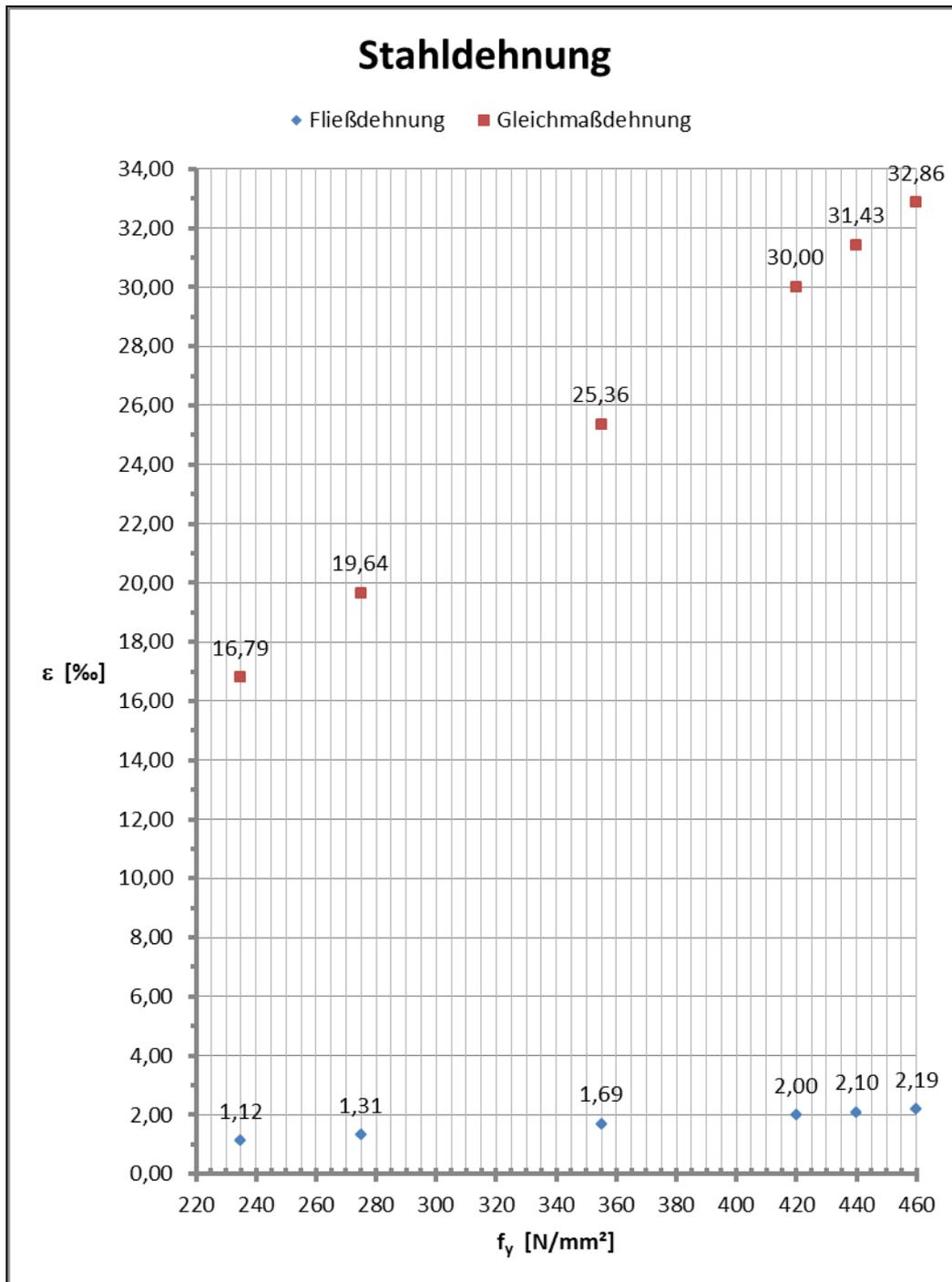
Mit Hilfe dieser Darlegungen und der Grafik kann sehr schnell die Einhaltung des Duktilitätskriteriums für Baustahl überprüft werden.
