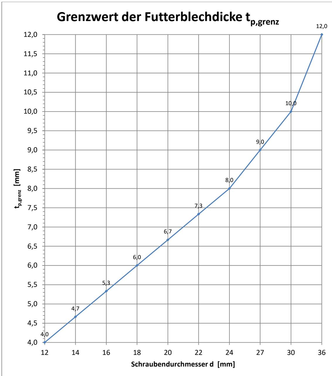
Bei kleineren Futterblechdicken  $t_p$  als im Diagramm angegeben, sind weitergehende Überlegungen nicht erforderlich. Anderenfalls muss die Abschertragfähigkeit  $F_{v,Rd}$  nach [1], Tabelle 3.4 mit einem Beiwert  $\beta_p$  abgemindert werden. Die Abschertragfähigkeit muss dann mit Hilfe der folgenden Gleichung berechnet werden.
