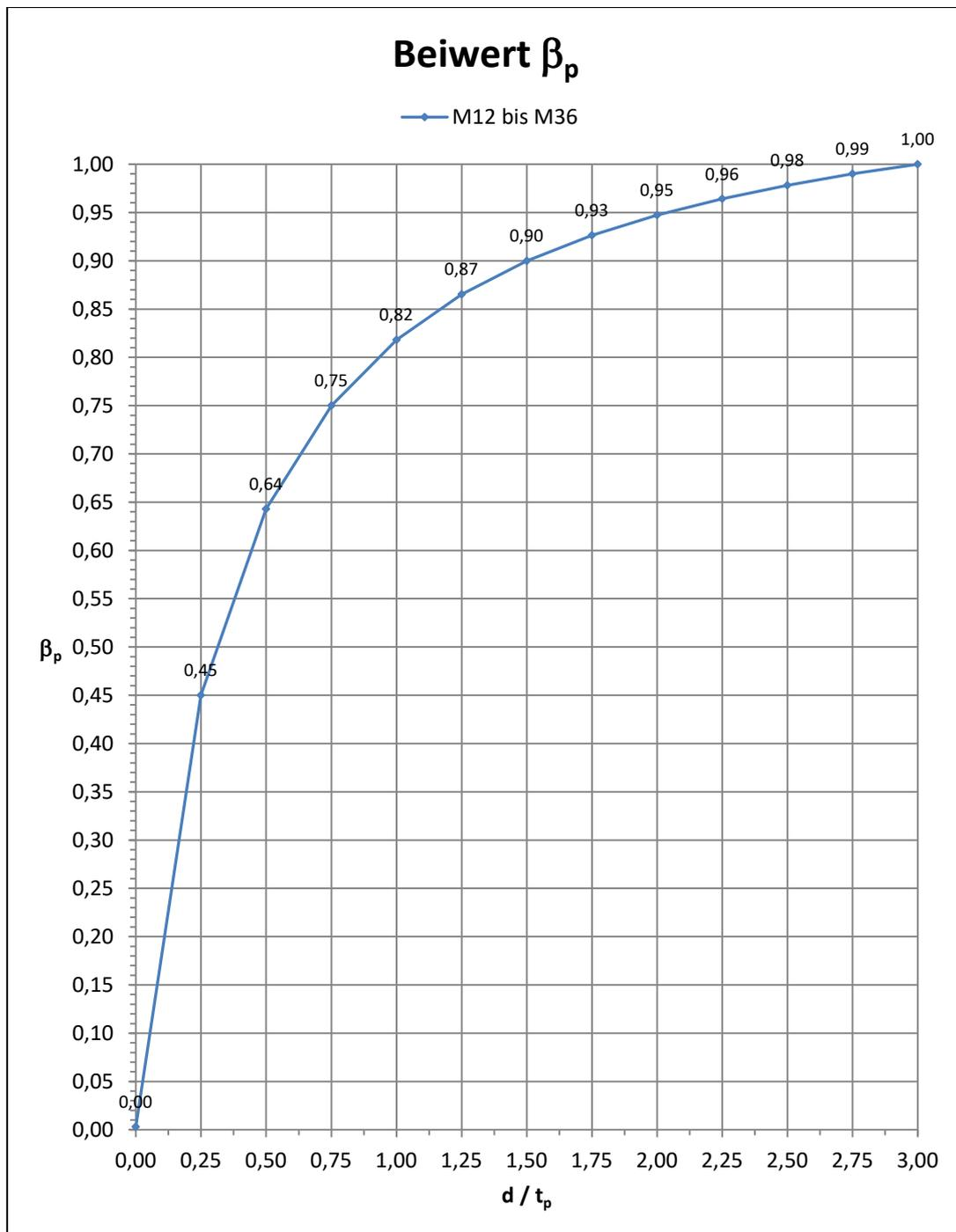
Aus diesem Diagramm wird ersichtlich, dass die obere Schranke  $\beta_p \leq 1,0$  nach [1], Abschnitt 3.6.1(12) nur relevant wäre, wenn  $\frac{d}{t_p} > 3,0$  ist. Da dies jedoch durch den gleichen Abschnitt von [1] bei einer
