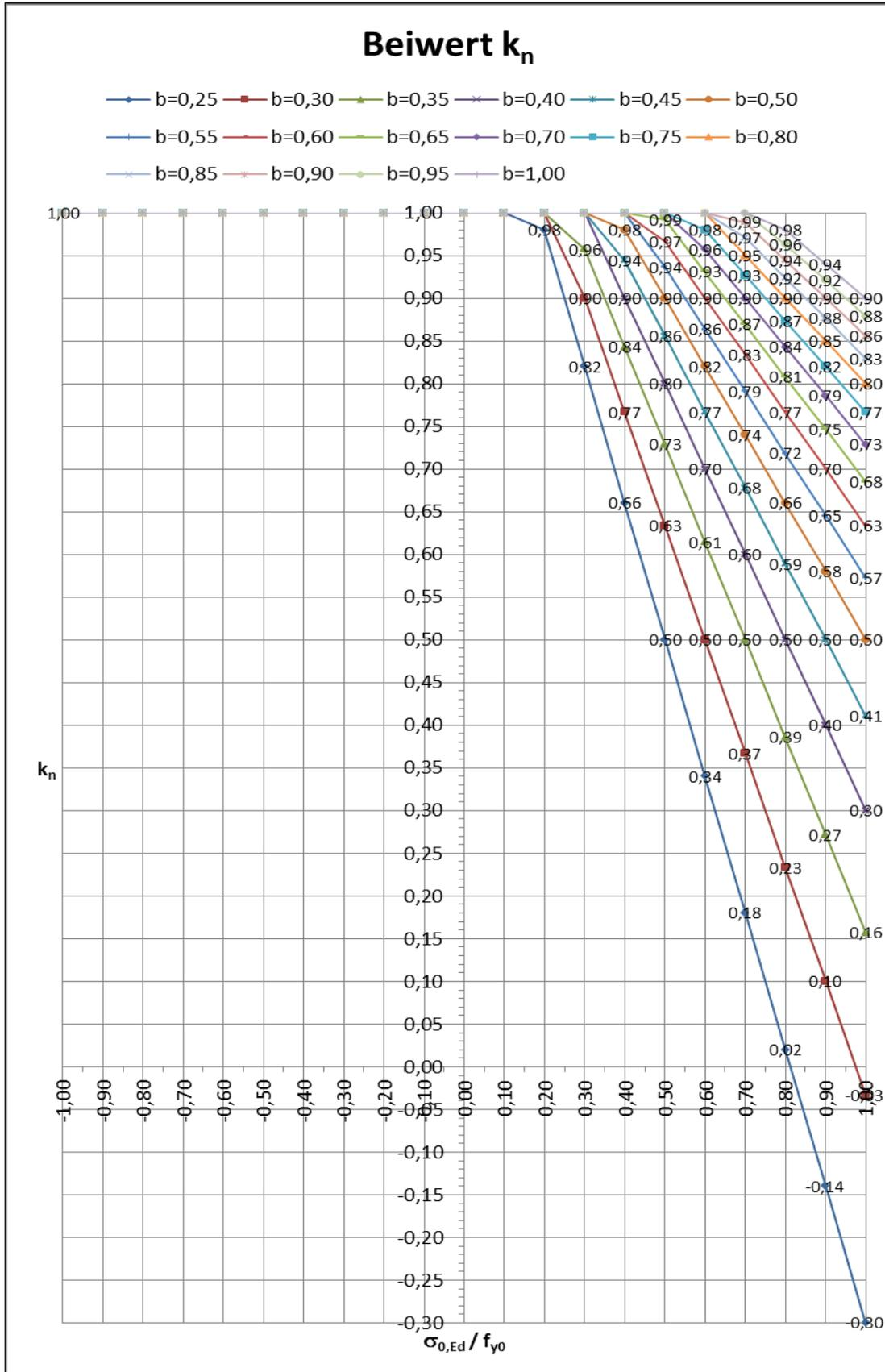
Mit Hilfe dieser Diagramme können der Schlankheitsgrad  $\bar{\lambda}$  und der Beiwerte  $k_n$  für ebene, geschweißte T-, X- und Y-Anschlüsse von RHP- bzw. KHP-Streben an RHP-Gurtstäbe einfacher bestimmt werden. Dadurch wird die umfangreiche Berechnung der Tragfähigkeit  $N_{Rd}$  dieser Anschlüsse etwas vereinfacht.
